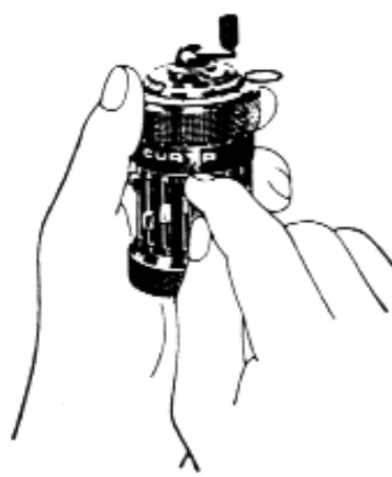
Bild 4. So wird die Zahleneinstellung vorgenommen
